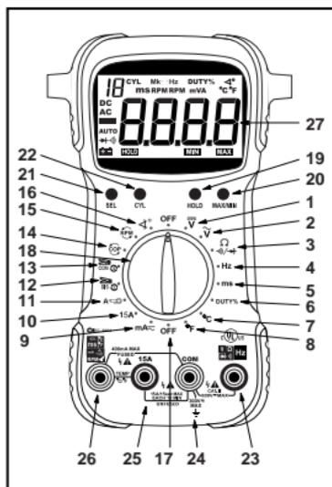
8. **Función de Temperatura (Fahrenheit):** Mide la temperatura en °F. Autodetección de temperatura desde -58 °F hasta +752 °F. (Requiere el uso de un termopar "tipo K" opcional).
