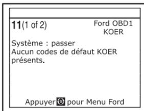
11. Une fois que l'outil de diagnostic a récupéré tous les CPD de l'auto-vérification KOER, arrêtez le moteur et débranchez l'outil de diagnostic des raccords de vérification du véhicule. Les CPD récupérés sont désormais sauvegardés dans la mémoire de l'outil de diagnostic.
