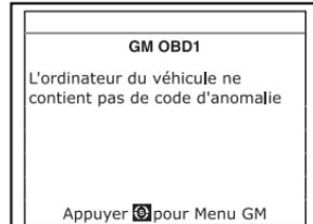
6. Si plus d'un code a été récupéré, appuyez sur le bouton **DTC/FF** (défilement des codes de problèmes), le cas échéant, pour afficher les codes additionnels un à la fois.
