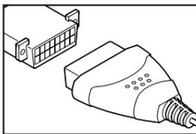
3. Raccordez le câble de l'outil de diagnostic sur le CLT du véhicule. Le connecteur du câble comporte un détrompeur ; il ne peut être installé que d'une seule manière.
