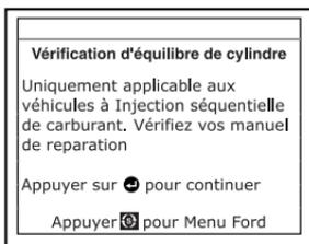
4. Démarrez et faites chauffer le moteur à une température de fonctionnement normal. Appuyez sur le bouton **ENTRÉE**
