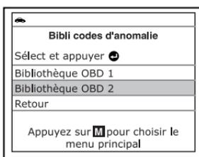
3. Utilisez au besoin les boutons **HAUT** (▲) et **BAS** (▼) pour mettre en surbrillance le type de code de diagnostic (P = groupe motopropulseur, U = réseau, B = carrosserie, C = châssis), puis appuyez sur le bouton **DTC/FF**.
