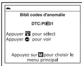
4. Sélectionnez les autres chiffres du code de diagnostic de la même façon, sans oublier d'appuyer sur le bouton **DTC/FF** pour confirmer chaque chiffre. Lorsque vous avez terminé de sélectionner tous les chiffres du code de diagnostic, appuyez sur le bouton **ENTRÉE** (↵) pour continuer.
