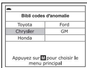
5. Utilisez au besoin les boutons **HAUT** (▲) et **BAS** (▼) pour mettre en surbrillance le constructeur du véhicule, puis appuyez sur le bouton **DTC/FF**.
