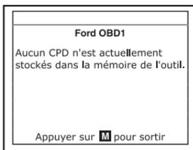
10. Si aucun problème n'est détecté durant l'auto-vérification KOER, l'ordinateur envoie un code « PASS » (code 11 ou 111) au outil de diagnostic. Le code 11 ou 111 indique que tous les relais et actionneurs, ainsi que leurs circuits connexes qui ont été vérifiés durant l'auto-vérification KOER sont bons et qu'aucune erreur n'a été détectée.
