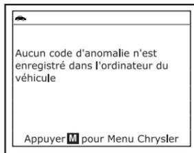
7. Si plus d'un code a été récupéré, appuyez sur le bouton **DTC/FF** (défilement des codes de problèmes), le cas échéant, pour afficher les codes additionnels un à la fois.
