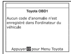
6. Si plus d'un code a été récupéré, appuyez sur le bouton **DTC/FF** (défilement des codes de problèmes), le cas échéant, pour afficher les codes additionnels un à la fois.
