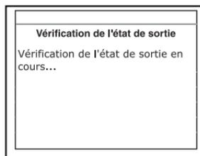
10. Lorsque l'écran le demande, appuyez sur la pédale de l'accélérateur une seule fois et relâchez-la. Ceci active la vérification d'état de sortie et excite la plupart des actionneurs (relais et solénoïdes) qui sont contrôlés par l'ordinateur du véhicule.
