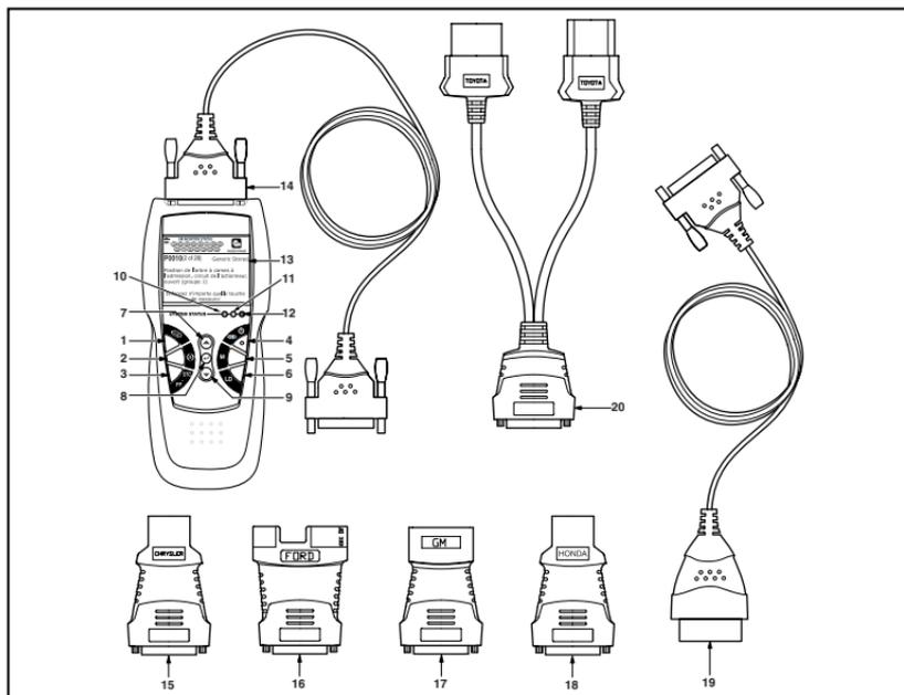
Figure 1. Contrôles et indicateurs
