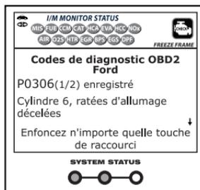
4. **Voyants lumineux clignotant en rouge et en jaune** - Ces voyants indiquent qu'un code permanent a été déclenché et qu'une ou plusieurs sondes du véhicule ont échoué le test de diagnostic. Un CPD « permanent » peut être effacé uniquement par l'ordinateur du véhicule après l'exécution réussie d'un cycle de la sonde ayant détecté l'anomalie.
