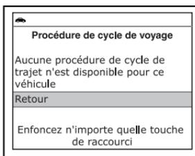
6. L'écran de la procédure de cycle de voyage affiche l'ensemble de procédures d'opération qui assurent que le véhicule soit conduit afin que tous les « critères d'activation » requis pour faire fonctionner le moniteur et donner un résultat soient remplis. Utilisez les boutons **HAUT ▲** et **BAS ▼**, au besoin, pour visualiser l'écran entier.
