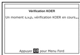
7. L'outil de diagnostic récupérera le code d'identification des cylindres. Le code d'identification des cylindres indique le nombre de cylindres du véhicule testé.
