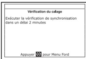
**Exemple** : Si la spécification de calage de base est à  $10^{\circ}$  avant PMH, le relevé acceptable de la lampe stroboscopique doit être dans la plage de  $27^{\circ}$  à  $33^{\circ}$  avant PMH.
