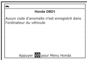
6. Si plusieurs codes ont été récupérés, appuyez au besoin sur le bouton **DTC/FF** pour afficher successivement les autres codes.
