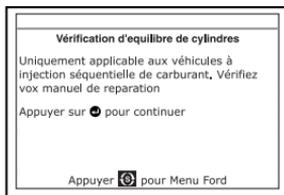
4. Un message d'instruction s'affiche. Démarrez et faites chauffer le moteur à une température de fonctionnement normal. Appuyez sur le bouton **ENTRÉE**
