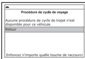
6. L'écran de la procédure de cycle de voyage affiche l'ensemble de procédures d'opération qui assurent que le véhicule soit conduit afin que tous les « critères d'activation » requis pour faire fonctionner le moniteur et donner un résultat soient remplis. Utilisez les boutons **HAUT ▲** et **BAS ▼**, au besoin, pour visualiser l'écran entier.
