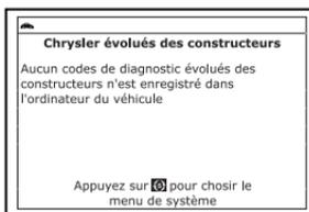
3. Si plusieurs codes ont été récupérés, appuyez au besoin sur le bouton **DTC/FF** (défilement des codes de problèmes) pour afficher successivement les autres codes.
