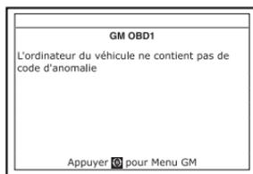
7. Si plus d'un code a été récupéré, appuyez sur le bouton **DTC/FF** (défilement des codes de problèmes), le cas échéant, pour afficher les codes additionnels un à la fois.
