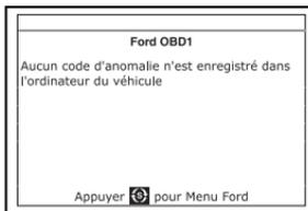
10. Si aucun problème n'est détecté durant l'auto-vérification KOER, l'ordinateur envoie un code « PASS » (code 11 ou 111) au outil de diagnostic. Le code 11 ou 111 indique que tous les relais et actionneurs, ainsi que leurs circuits connexes qui ont été vérifiés durant l'auto-vérification KOER sont bons et qu'aucune erreur n'a été détectée.
