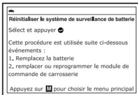
4. Suivre les instructions fournies pour préparer le véhicule en vue du service de réinitialisation de la batterie OBD. Lorsque toutes les procédures ont été effectuées, utiliser les boutons **HAUT** ▲ et **BAS** ▼, au besoin, pour mettre en surbrillance **Suivant**, puis appuyer sur le bouton **ENTRÉE** ↵.
