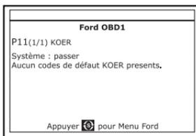
11. Une fois que l'outil de diagnostic a récupéré tous les CPD de l'auto-vérification KOER, arrêtez le moteur et débranchez l'outil de diagnostic des raccords de vérification du véhicule. Les CPD récupérés sont désormais sauvegardés dans la mémoire de l'outil de diagnostic.
