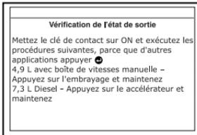
6. Tournez le contact sur ON. NE FAITES PAS démarrer le moteur. Si votre véhicule est équipé de l'un des types de moteur suivants, effectuez les procédures additionnelles décrites ci-dessous :
