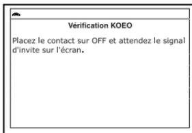
6. Mettez le contact. **NE DÉMARREZ PAS** le moteur. Si votre véhicule est équipé de l'un des types de moteur suivants, effectuez les procédures additionnelles décrites ci-dessous :
