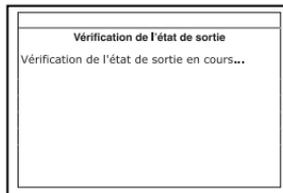
10. Lorsque l'écran le demande, appuyez sur la pédale de l'accélérateur une seule fois et relâchez-la. Ceci active la vérification d'état de sortie et excite la plupart des actionneurs (relais et solénoïdes) qui sont contrôlés par l'ordinateur du véhicule.
