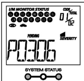
**ESTADO DEL MONITOR** - Si la pantalla LCD del Lector de Códigos muestra el mensaje **0 DTC** (para indicar que no hay DTC presentes en la computadora del vehículo), pero el LED amarillo está encendido, esto indica el estado "El monitor no ha funcionado". Lo cual significa que algunos de los monitores en el vehículo aún no han terminado sus pruebas automáticas de diagnóstico.
