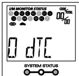
Esta condición la confirman uno o más iconos de monitor **intermitentes** en la pantalla LCD. Un icono de monitor **intermitente** significa que el monitor aún no ha funcionado ni ha terminado sus pruebas automáticas de diagnóstico. Todos los iconos de monitor iluminados de manera **continua** ya han terminado sus pruebas automáticas de diagnóstico.
