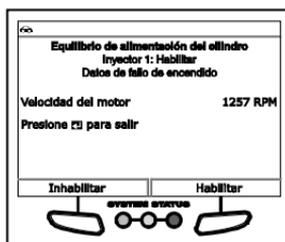
4. Seleccione **Inhabilitar** para inhabilitar el inyector de combustible seleccionado y observar el cambio en la **Velocidad del motor**.
