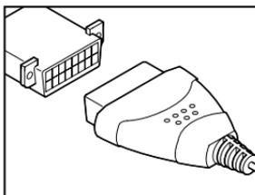
3. Raccordez le câble de l'outil de diagnostic sur le CLT du véhicule. Le connecteur du câble comporte un détrompeur ; il ne peut être installé que d'une seule manière.
