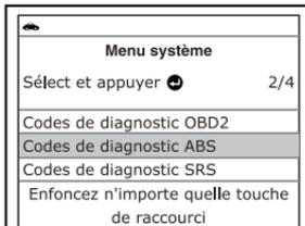
**Pour voir les codes SRS :** Sélectionnez **Codes de diagnostic SRS** dans le menu de système. Pour plus de détails sur l'affichage des codes SRS du véhicule, reportez-vous en page 63 sous **AFFICHAGE DES CODES SRS**.
