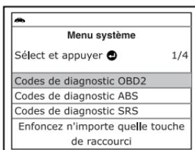
**Pour voir les codes ABS :** Sélectionnez **Codes de diagnostic ABS** dans le menu de système. Pour plus de détails sur l'affichage des codes ABS du véhicule, reportez-vous en page 61 sous **AFFICHAGE DES CODES ABS**.
