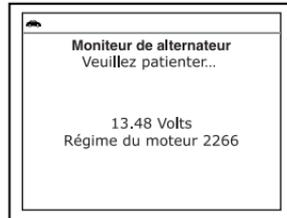
7. Lorsque le contrôle de l'alternateur est terminé, un écran de résultats affiche les valeurs de tension du système de chargement et indique si oui ou non le système de charge est dans des limites acceptables. Les DEL de statut système fournissent une indication de la réussite ou l'échec comme suit :
