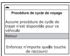
6. L'écran de la procédure de cycle de voyage affiche l'ensemble de procédures d'opération qui assurent que le véhicule soit conduit afin que tous les « critères d'activation » requis pour faire fonctionner le moniteur et donner un résultat soient remplis. Utilisez les boutons **HAUT ▲** et **BAS ▼**, au besoin, pour visualiser l'écran entier.
