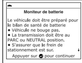
4. Préparation du véhicule pour la vérification de la batterie :
