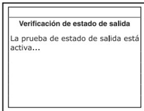
10. Cuando está incitado, oprima una vez el pedal del acelerador, después suéltelo. Esto activa la Verificación de estado de salida y energiza la mayoría de los accionadores (relés y solenoides) que se controlan desde la computadora del vehículo.
