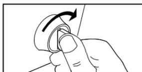
3. Coloque la llave de la ignición en la posición ON. NO ponga en marcha el motor.
