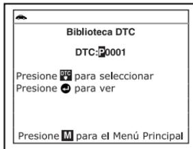
4. Seleccione los dígitos restantes en el DTC de la misma manera, oprima el botón **DTC/FF** para confirmar cada dígito. Cuando haya seleccionado todos los dígitos de DTC, oprima el botón **INTRO** para continuar.
