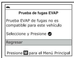
3. Cuando la prueba de fugas EVAP ha sido iniciada por la computadora a bordo del vehículo, un mensaje de confirmación se muestra en pantalla de la herramienta de diagnóstico. Use los botones **ARRIBA** (▲) y **ABAJO** (▼), según sea necesario, para seleccionar **Regresar** y oprima el botón **INTRO** (⏏) para regresar al menú **Prueba de Sistema**, o bien, oprima el botón **M** para regresar al Menú principal.
