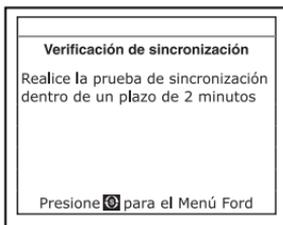
**Ejemplo:** Si la especificación de la sincronización base es de  $10^{\circ}$  BTDC, la lectura aceptable de la lámpara de sincronización deberá encontrarse entre  $27^{\circ}$  y  $33^{\circ}$  BTDC.
