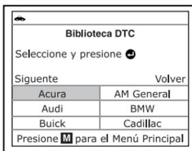
5. Use los botones **ARRIBA** y **ABAJO**, según sea necesario, para seleccionar el fabricante del vehículo deseado, después oprima el botón del **DTC/FF**.
