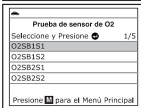
3. Use los botones **ARRIBA** (▲) y **ABAJO** (▼), según sea necesario, para resultar el sensor de O<sub>2</sub> para el cual desea ver los resultados de las pruebas, después pulse el botón **INTRO** (↵).
