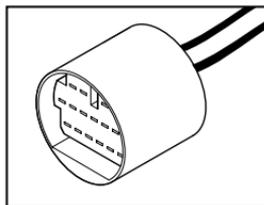
Puede tener una capa protectora que es necesario retirarla para poder conectar el DLC de la herramienta de diagnóstico. Utilice la cabeza circular del adaptador de cable con conector Toyota en vehículos con este tipo de conector.
