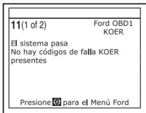
11. Después que la herramienta de diagnóstico recupera todos los DTC de la autopruueba KOER, apague el motor, y desconecte la herramienta de diagnóstico de los conectores de prueba del vehículo. Los DTC recuperados ahora están guardados en la memoria de la herramienta de diagnóstico.
