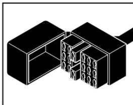
Tiene una cubierta rotulada con "DIAGNOSTIC", "DIAGNOSIS", o "CHECK CONN". Utilice la cabeza cuadrada del adaptador de cable con conector Toyota en vehículos con este tipo de conector.
