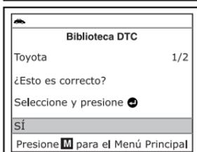
6. Cuando haya terminado de ver la definición del DTC, use los botones **ARRIBA** (▲) y **ABAJO** (▼), según sea necesario, para seleccionar **Regresar** y después oprima el botón **INTRO** (↵) para regresar a la pantalla de Introducir DTC o introducir DTC adicional, o bien, oprima el botón **M** para regresar al Menú principal.
