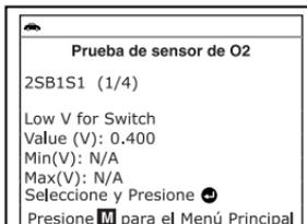
5. Cuando haya terminado de ver los datos recuperados de las pruebas, use los botones **ARRIBA** (▲) y **ABAJO** (▼), según sea necesario, para seleccionar **Regresar** y después oprima el botón **INTRO** (↵) para volver a la pantalla Selección del Sensor.
