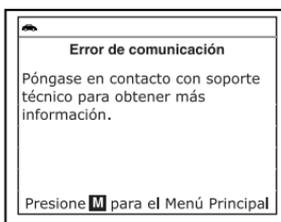
9. Si la herramienta de diagnóstico logra conectarse con éxito con el vehículo aparecerá temporalmente en la pantalla de LCD de la herramienta de diagnóstico el mensaje "Code retrieval was successful..." (La recuperación de códigos se realizó con éxito) seguido por cualquier DTC recuperado.
