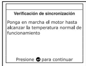
6. Cuando se le indique en la pantalla, apague todos los accesorios del vehículo, gire la llave de encendido en la posición de APAGADO y espere la indicación en la pantalla. Si desea salir del procedimiento de Comprobación de la Sincronización en este momento, oprima el botón **MENÚ DEL SISTEMA** (S).
