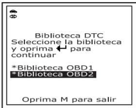
4. Use el botón **ABAJO** (⏏) para desplazarse hasta el tipo de código de fallo DTC requerido (P = Tren de potencia, U = Red, B = Carrocería, C = Chasis), después pulse el botón **DTC** (Desplazarse por DTC).
