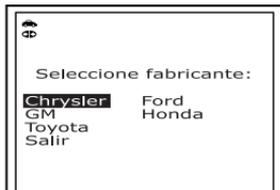
4. Use los botones **ARRIBA** (▲) y **ABAJO** (▼), según sea necesario, para resaltar el fabricante de vehículo deseado, después pulse el botón **INTRO** (↵).
