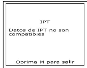
5. Si el vehículo sujeto de la prueba no es compatible con el Rastreo de desempeño en uso, en la pantalla de la herramienta de diagnóstico aparece un mensaje de advertencia. Pulse el botón **M** (Menú) para salir.
