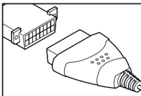
3. Acople el conector de cables de la herramienta de diagnóstico al DLC del vehículo. El conector de cables tiene guías para el acoplamiento correcto.
