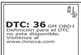
8. Si desea ver definiciones de DTC adicionales, pulse el botón **M** para volver a la pantalla Introducir DTC, y repita los pasos **5** y **6**.
