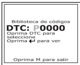
5. De la misma manera, seleccione los caracteres restantes en el DTC, y pulse el botón **DTC** (Desplazarse por DTC) para confirmar cada carácter. Después de seleccionar todos los caracteres DTC, pulse el botón **INTRO** (↵) para visualizar la definición del código de fallo DTC.
