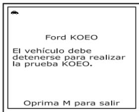
2. En la pantalla de la herramienta de diagnóstico aparece un mensaje "instructivo". Lleve a cabo los procedimientos de prueba según corresponda.
