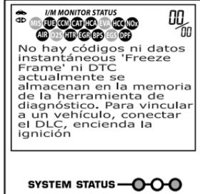
que se encienda de manera continua indica el estado "Se ha ejecutado" del monitor, un icono de monitor intermitente indica el estado "No se ha ejecutado"). Lleve esta información a un profesional de pruebas de emisiones para que determine (con base en los resultados de sus pruebas) si su vehículo está listo para una prueba de emisiones (verificación de contaminación ambiental).
