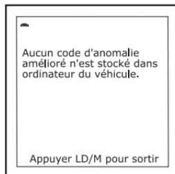
4. Si plusieurs codes ont été récupérés, appuyez au besoin sur le bouton **DTC / FF** (défilement des codes de problèmes/données gelées) pour afficher successivement les autres codes.
