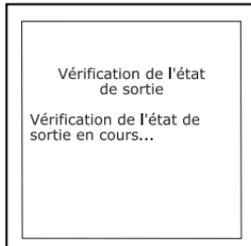
10. Lorsque l'écran le demande, appuyez sur la pédale de l'accélérateur une seule fois et relâchez-la. Ceci active la vérification d'état de sortie et excite la plupart des actionneurs (relais et solénoïdes) qui sont contrôlés par l'ordinateur du véhicule.
