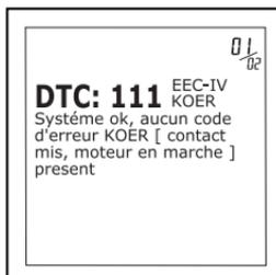
11. Une fois que l'outil de diagnostic a récupéré tous les CPD de l'auto-vérification KOER, arrêtez le moteur et débranchez l'outil de diagnostic des raccords de vérification du véhicule. Les CPD récupérés sont désormais sauvegardés dans la mémoire d'outil de diagnostic.
