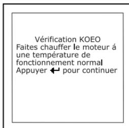
4. Démarrez et faites chauffer le moteur à une température de fonctionnement normal. Appuyez sur le bouton **ENTRÉE**
