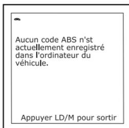
4. Si plusieurs codes ont été récupérés, appuyez au besoin sur le bouton **DTC/FF** pour afficher successivement les autres codes.
