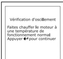
4. Démarrez et faites chauffer le moteur à une température de fonctionnement normal. Appuyez sur le bouton **ENTRÉE** ←↵ pour continuer.
