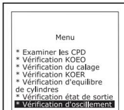
3. À partir du menu de Système Ford OBD1, mettez en surbrillance la **KOEO Test** (vérification KOEO) puis appuyer sur le bouton **ENTRÉE**
